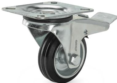
Este rodízio permite movimentar a roda em 360°, tornando as deslocações mais fáceis, especialmente em espaços de dimensões reduzidas. A sua construção metálica com tratamento galvanizado assegura durabilidade, enquanto o sistema giratório garante fluidez nas manobras. Para além disto, está equipado com um travão que possibilita o bloqueio da roda quando necessário, assegurando o travamento e imobilização da mesma.
