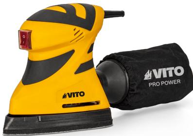
Ponceuse multi d'une puissance de 180W, tension d'alimentation de 230V 50Hz, vitesse de rotation 12000tpm, vitesse d'oscillation 12000 - 22000opm et amplitude d'oscillation 1.8mm, comprend 2 plateaux oscillantes (triangulaire+carrée).
